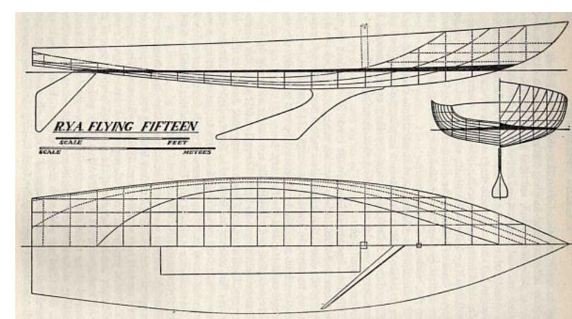
Les méthodes de construction dans les premières années étaient très variées, bordé traditionnel, contreplaqué moulé, aluminium, composites laminés et fibre de verre étant utilisés, avant que les constructions récentes ne s'arrêtent sur un sandwich sous vide verre-epoxy et mousse avec des renforts carbone dans les zones de forte contrainte, ce qui donne une structure nettement plus rigide et une meilleure durée de vie, au niveau le plus compétitif.
