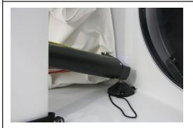
Bien préparer le mat en mettant les câbles clairs. Après avoir détendu les ridoirs, fixer les haubans sur le trou avant des cadènes de haubans. Enlever l'axe de pied de mât. Déposer le pied du mât sur la rotule en tenant le mât profil à plat sur bâbord de la quille, ralingue à bâbord. Remettre l'axe de pied de mât. La pose de l'écrou n'est pas nécessaire à cet instant.
