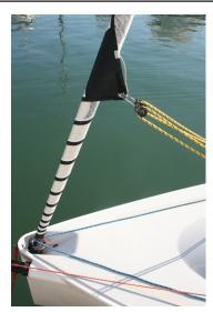
Attention, l'étarquage de la drisse de foc tend le tissus et creuse alors le bord d'attaque. Si une certaine tension est souhaitable, trop forte, elle empêchera de faire un bon cap et endommagera la voile, surtout si la tension est laissée entre les temps de navigation. Pour que l'emmagasineur fonctionne, il faut l'amorcer. Tendre la commande d'emmagasineur et la bloquer au taquet.
