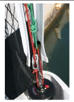
Fixer le point d'amure du foc à la latte ridoir avec la manille. Une fois le foc en haut, réaliser une boucle dans la drisse descendante. Le « bout de clam » préalablement fixé au clam, doit passer dans cette boucle avant de redescendre dans le clam par la roulette. Vous avez réalisé un palan de tension du guindant de foc à 2 brins.
