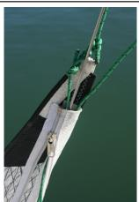
Fixer la drisse de foc par un noeud de chaise sur le point de drisse. Fermer la fermeture éclair sur 10 cm de large autour de l'étai. Passer la drisse descendant à l'intérieur. La remonter le long de l'étai et fixer sur le premier noeud de chaise. Vous avez réalisé un circuit en continu et votre drisse n'encombrera pas le bas de la voile. Hisser progressivement en fermant au fur et à mesure la fermeture éclair.
